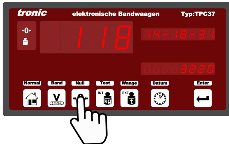
3. Durch drücken der „**ENTER**“ - Taste wird die Tarierung gestartet. Solange die Tarierung läuft, wird links neben Anzeige 1 das Tarierungs-Zeichen markiert.
