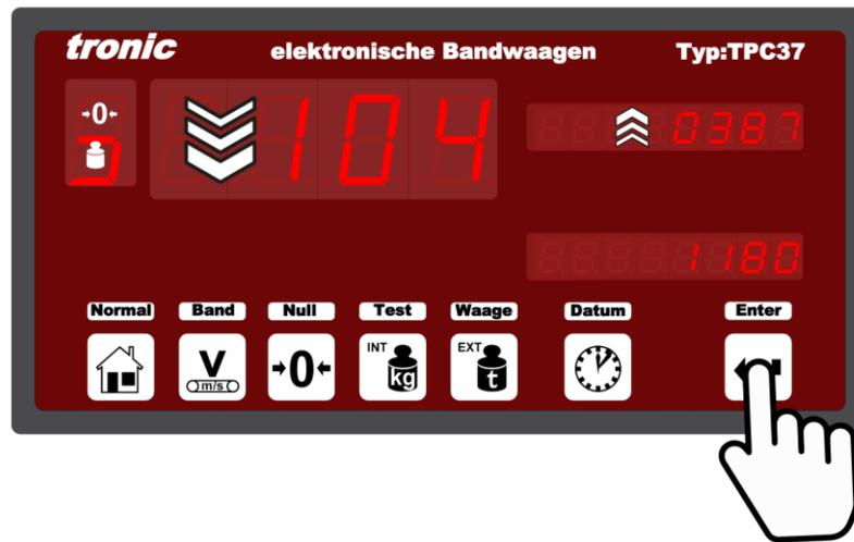
5. Durch erneutes drücken der „ENTER“ - Taste wird der Wert in Anzeige 2 dem Sollwert in Anzeige 3 angepasst. In Anzeige 1 erscheinen kurz die Buchstaben „-CAL-“, danach stellt die Waage automatisch auf Normalbetrieb um.
